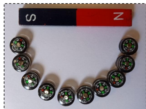
Aimant droit et boussoles alignées le long d'une ligne de champ
