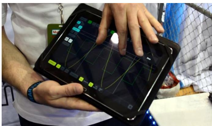
Tablette avec un oscilloscope pour mesurer les fréquences
