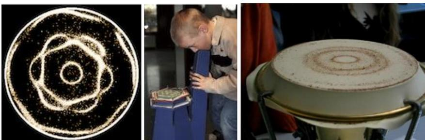
Visualiser des ondes avec un tonoscope
