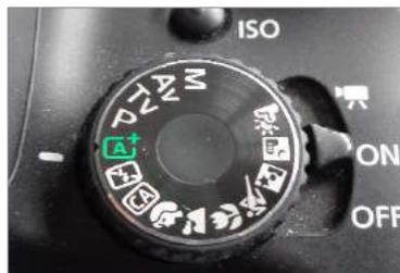
*Molette de réglage. Le mode automatique A+ est sélectionné.*
