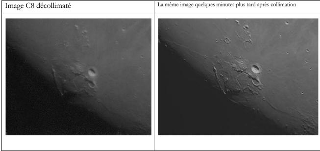
La méthode la plus efficace est visuelle; elle consiste à pointer une étoile de magnitude 2 à 4 très haute dans le ciel (de façon à minimiser la turbulence). On grossit 2 fois le diamètre de l'instrument (au minimum) soit 400 fois avec le C8.
