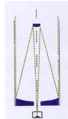
Combinaison optique de type cassegrain. On observe derrière le miroir principal.
