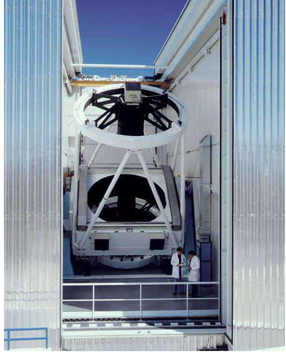
Le télescope NTT de 3,50 m de l'ESO au Chili sur sa monture azimutale. © ESO.
