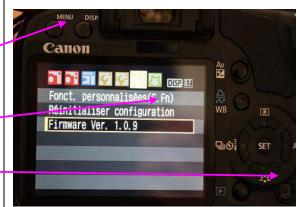
> Activer le verrouillage du miroir : fonction 9 (en fonction des modèles d'APN).
