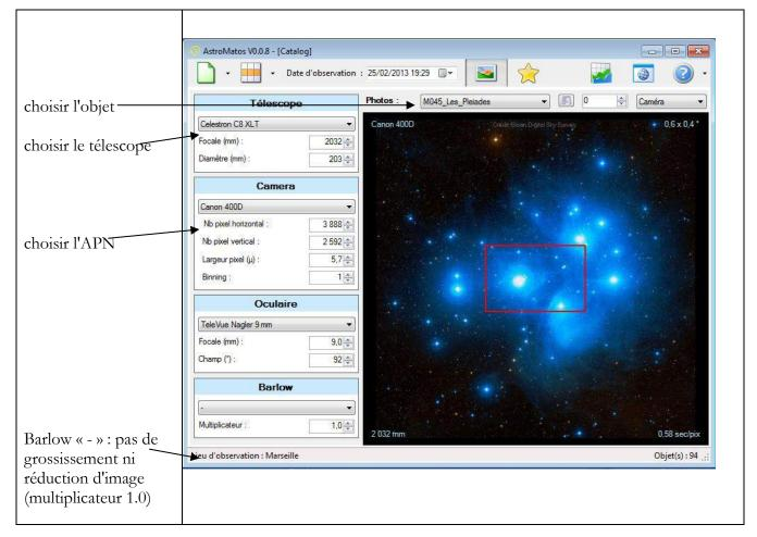
On voit que le champ obtenu est trop petit, on peut l'augmenter avec le réducteur de focale de 0.6 que l'on place à la sortie du tube du C8. On donne au multiplicateur la valeur 0.6.
