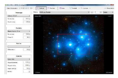
Le champ est encore insuffisant, il est préférable d'opter pour un instrument ayant une focale plus courte.
