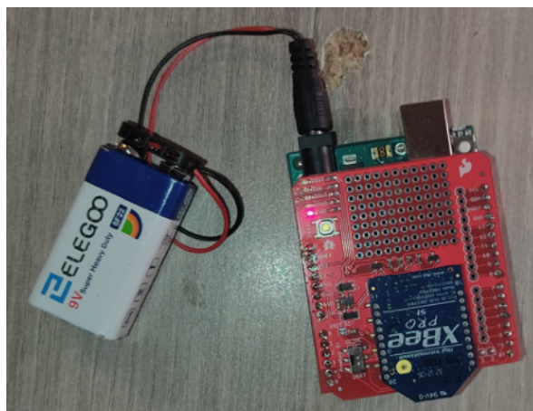
Xbee S1 Pro en fonctionnement autonome
