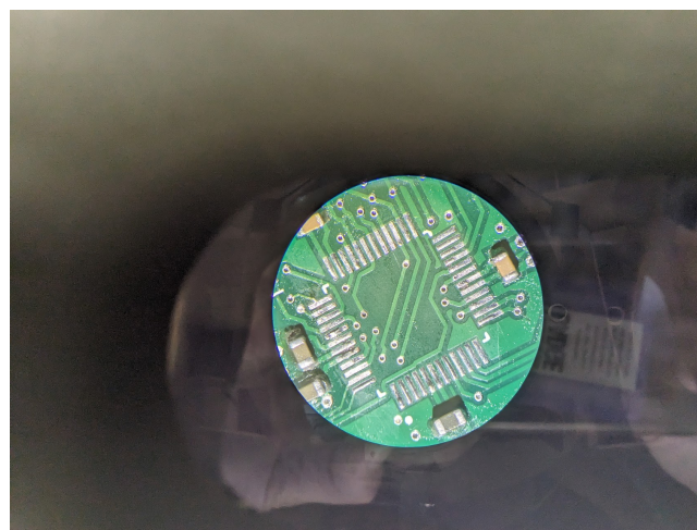
FIGURE 11 – Photo des pistes en mauvais état suite à un court-circuit (rangée de gauche)
