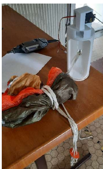
Photographie du parachute et de son espace de rangement. On remarque qu'un trou est fait pour que le parachute soit attaché à la fusée.
