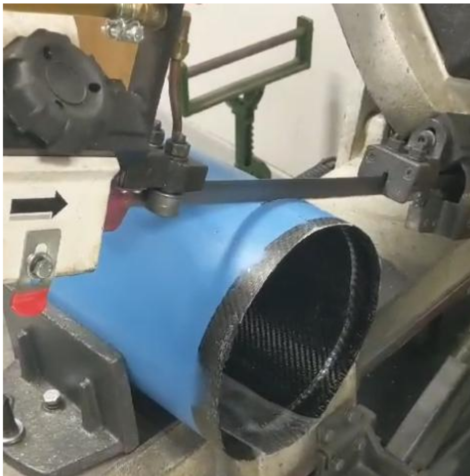
Figure 52 : découpage de la peau en carbone
