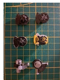
Figure 22 - Les barillets qui se cassent
