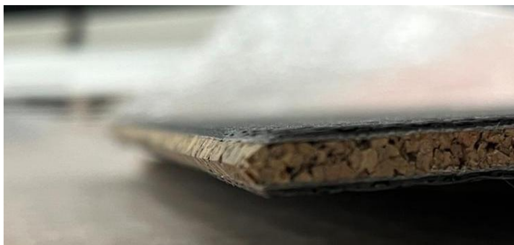
Figure 54 : empilement des couches des ailerons (liège-fibre de verre-fibre de carbone)
