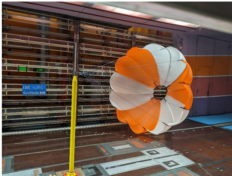
Figure 17 – Essai du parachute principal dans la soufflerie S10 de l'IAT
