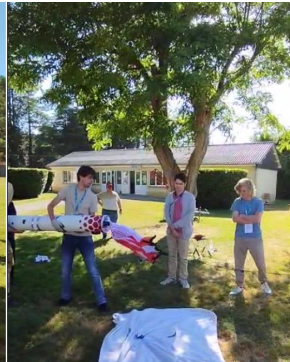
Figure 77 : activation 3 anneaux et déploiement main
