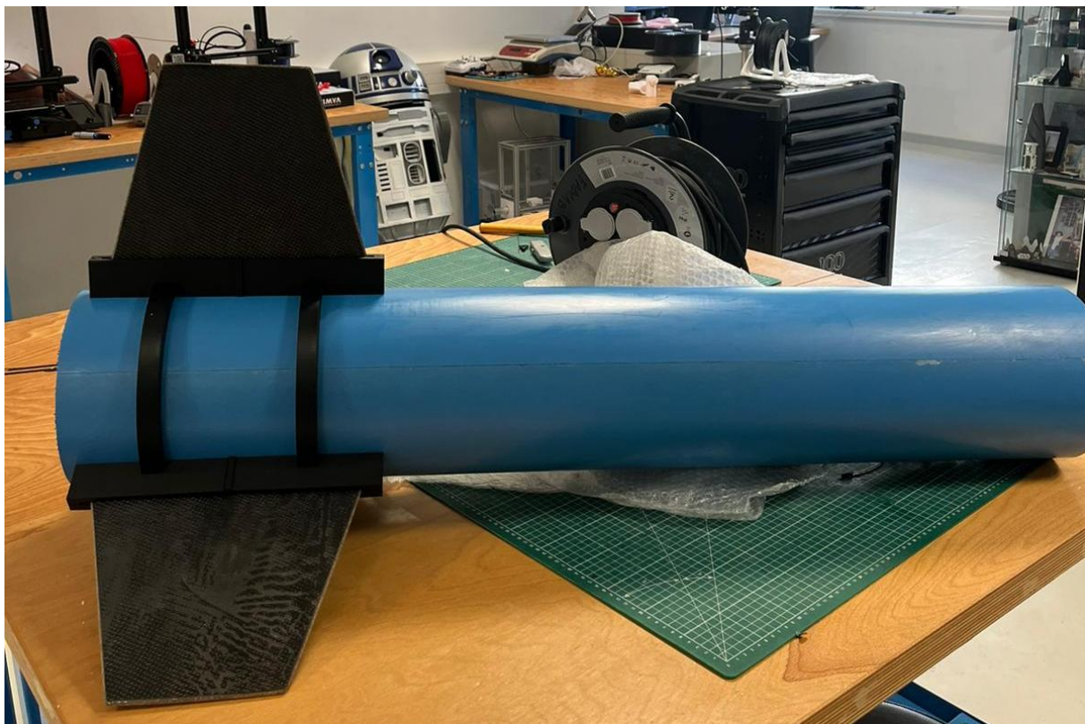
Figure 55 : Alignement des ailerons avec gabarit
