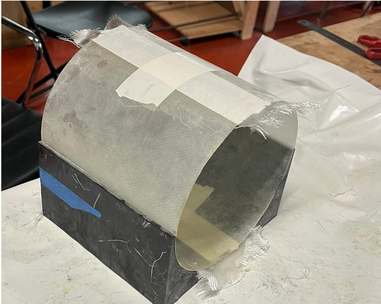
Figure 53 : Fabrication de la peau de la section avionique
