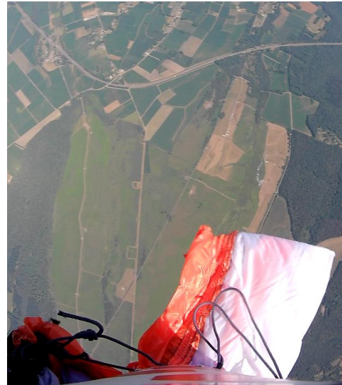
Figure 82 – Le main tombe de la fusée dès l'éjection de la coiffe
