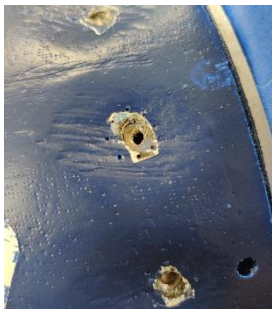
Figure 66: Trou de vis au niveau de la peau (post C'Space 2024)
