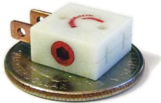
Nouveau switch rotatif traditionnel à vis
