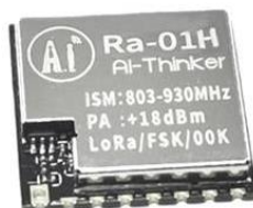
Figure 21 - Module LoRa RA-01H d'AI Thinker
