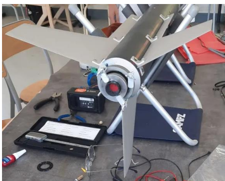
Figure 30 - Aperçu du train arrière intégrant l'adaptation muni du propulseur de test inséré
