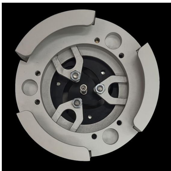
Figure 7 – Vue du dessus du mécanisme du système de séparation (ci-à gauche) Servo QY324MG (ci-à droite)
