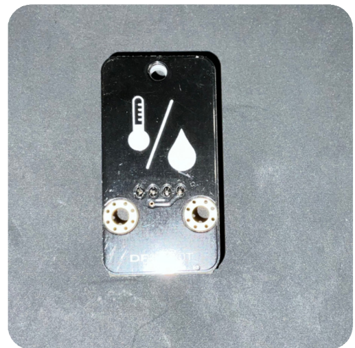
Capteur de température et d'humidité
