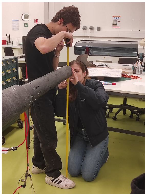
(a) Test de flèche réalisé avec un mètre
