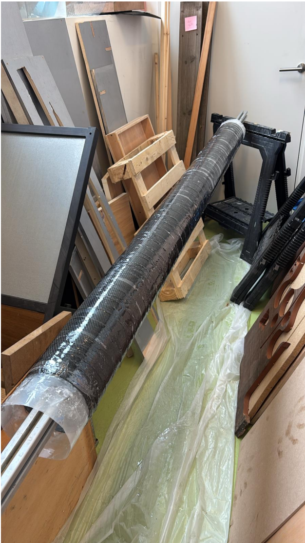
FIGURE 2.16 – Le tube de l’étage beta juste avant le démoulage : le tube moulé mesure ici 1m80 de façon à avoir suffisamment de marge (20 cm) pour le découper et l’usiner par la suite. Une équipe de 10 personnes a été mobilisé pour la fabrication avec des postes et des rôles bien précis assignés à chacun
