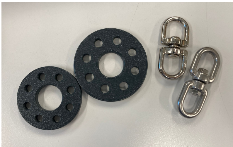
FIGURE 2.9 – Anneaux (en haut) et émerillons (en bas) des parachutes. Les deux émerillons sont identiques pour les deux parachutes. L’anneau de Beta a un diamètre plus important, adapté au diamètre supérieur de ses suspentes.
