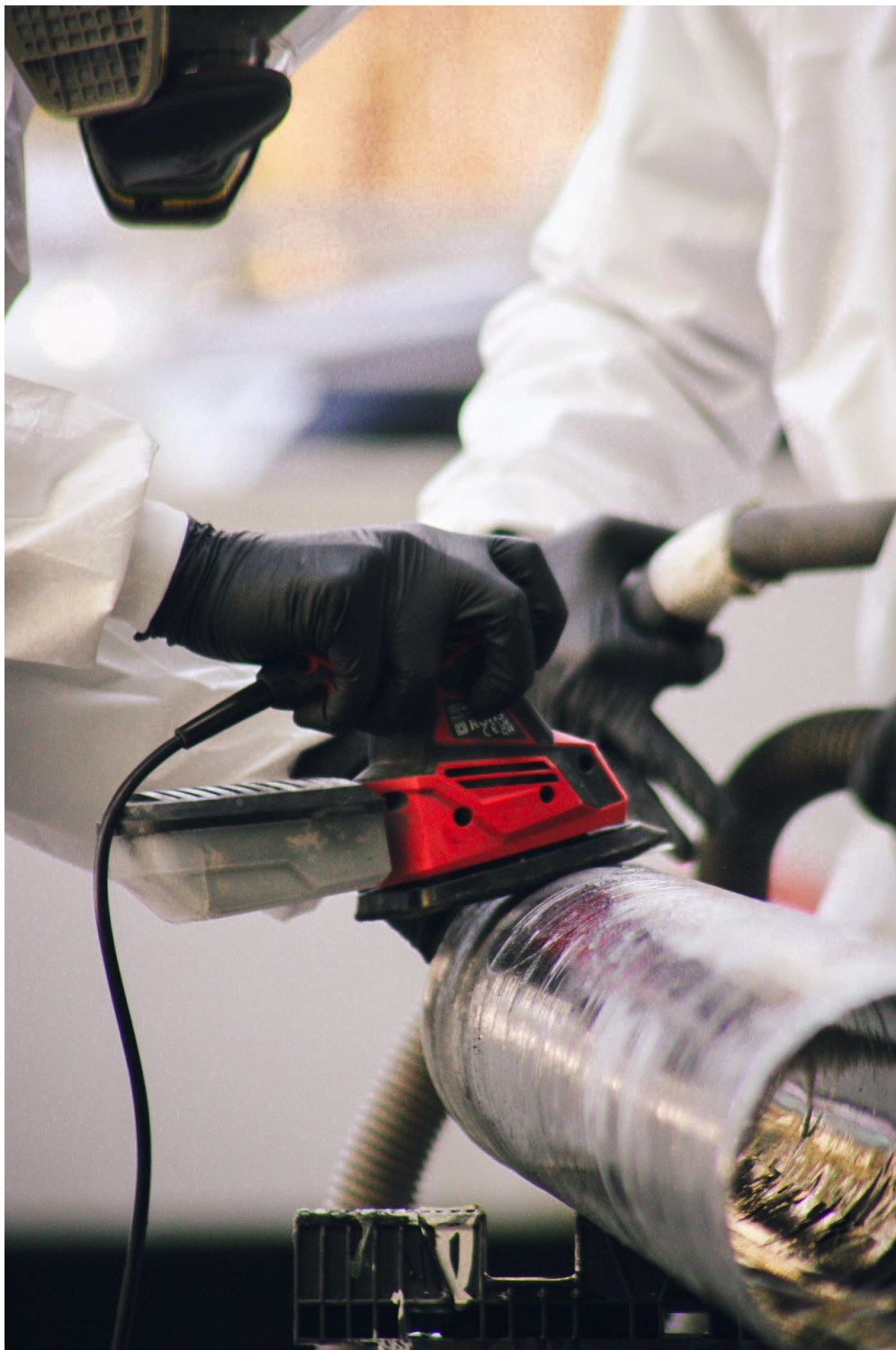
FIGURE 2.20 – Ponçage de la surface extérieure du tube en carbone
