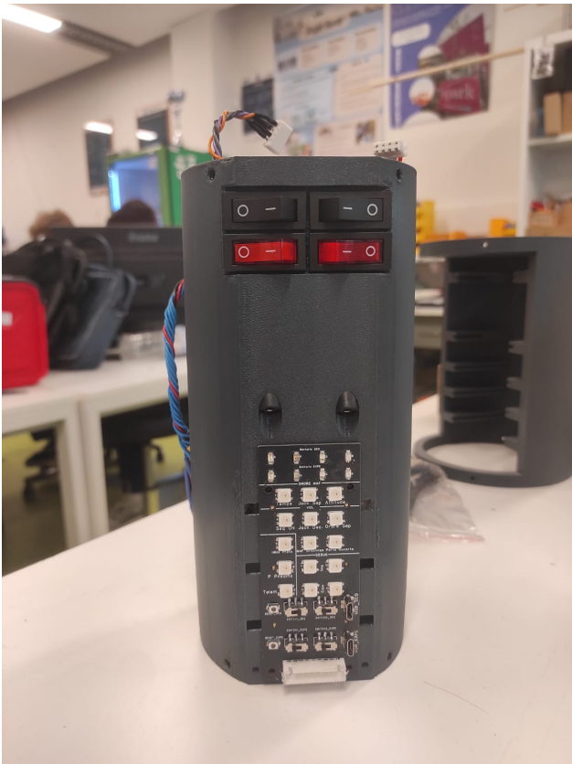
FIGURE 3.3 – Stack \beta vu de face. Du haut vers le bas, on trouve : les interrupteurs (les deux noirs pour inflammateur, et les deux rouges pour Séquenceur et Expériences), des emplacements pour les jacks et la carte Interface
