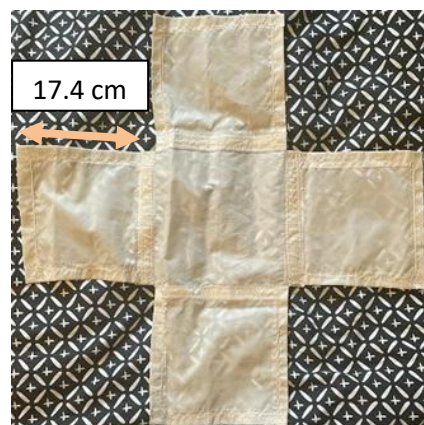
Annexe 5 : À gauche : Exemple de CANSAT avec parachute cruciforme déployé.
