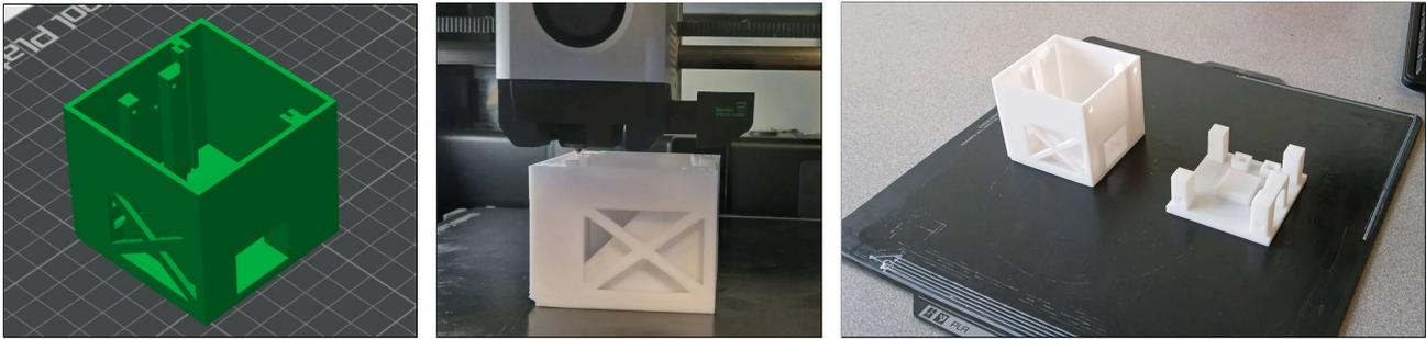
FIGURE 83 – Modèle 3D sur Bambu Studio, Impression dans une Bambu Lab, Résultat d'impression
