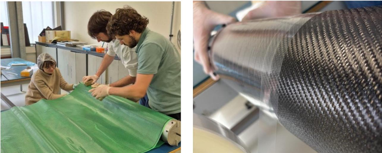
FIGURE 7 – Fabrication des peaux
