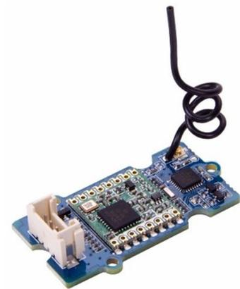
FIGURE 92 – Module LoRaWAN
