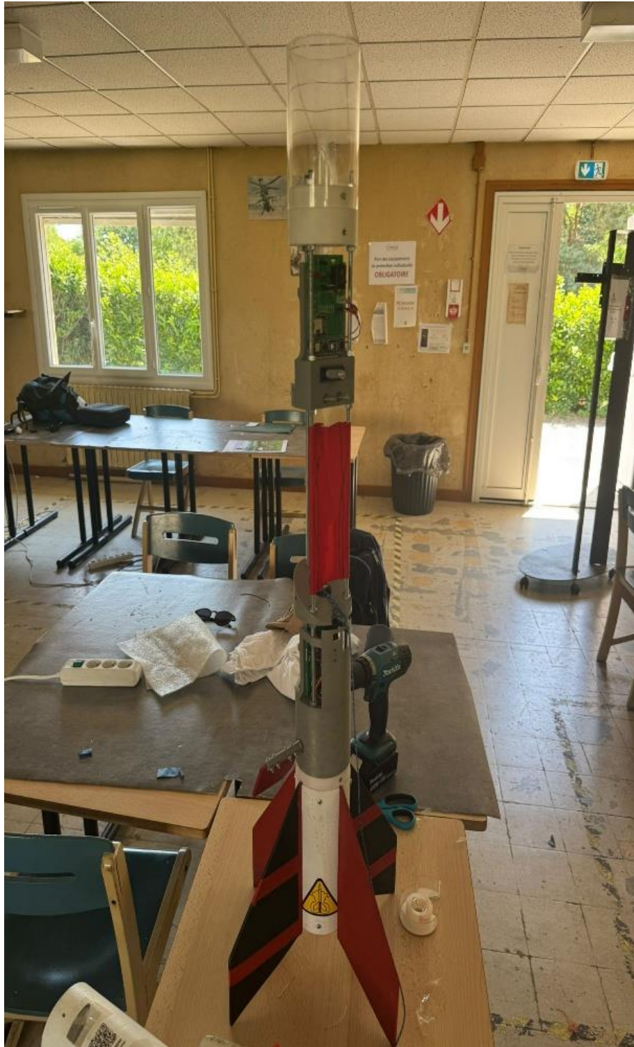
Figure : Intégration de notre carte (parachute) dans la fusée.
