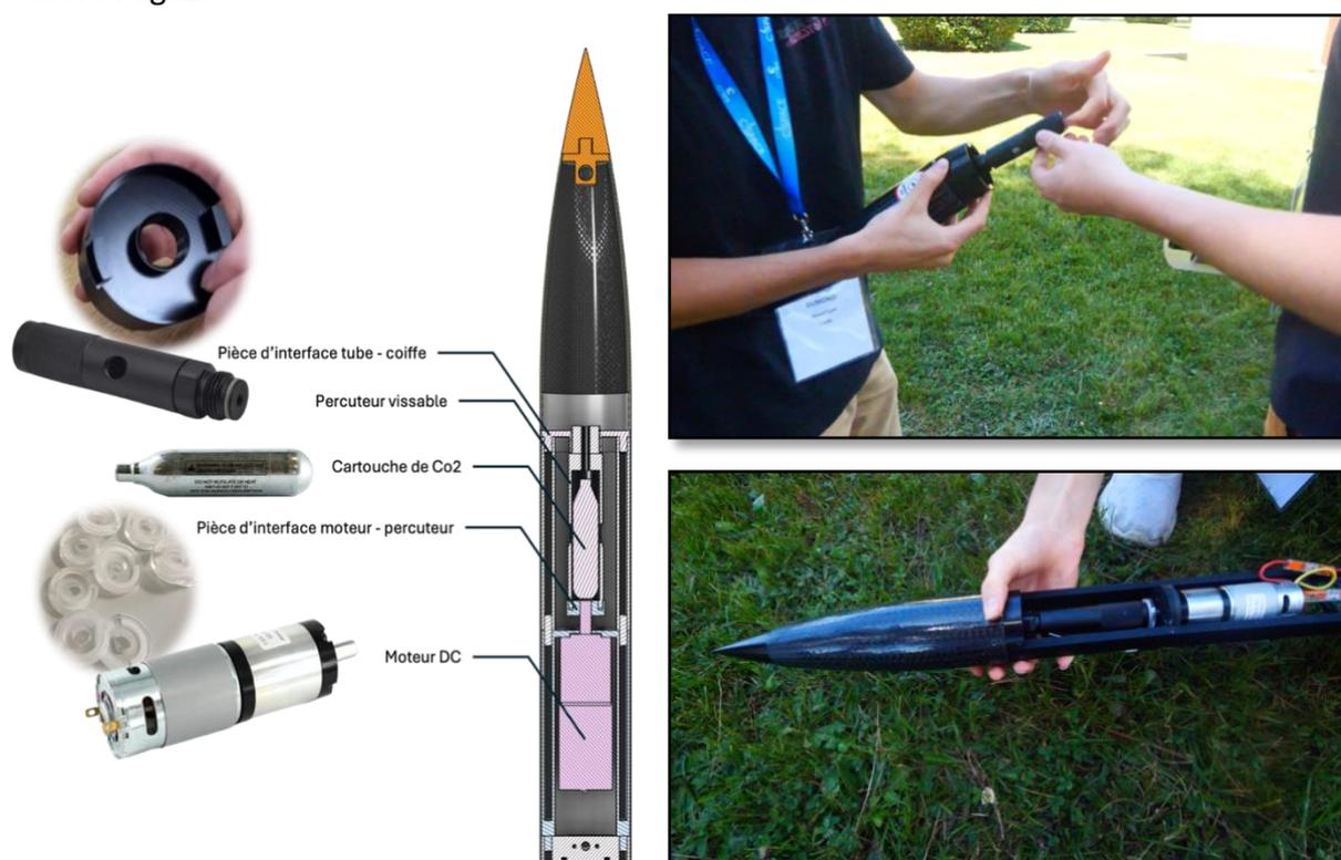
La tête du percuteur étant filetée par son extérieur, nous avons fait usiner une pièce d'interface en aluminium, emboîtée et fixée dans le tube, sur laquelle la coiffe vient se glisser et avec en son centre un trou fileté pour y visser le percuteur.
