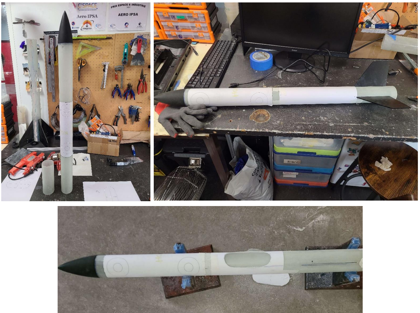
Figure 1, 2 et 3 : Tube d'HORIZON avec coiffe et ailerons en assemblage
