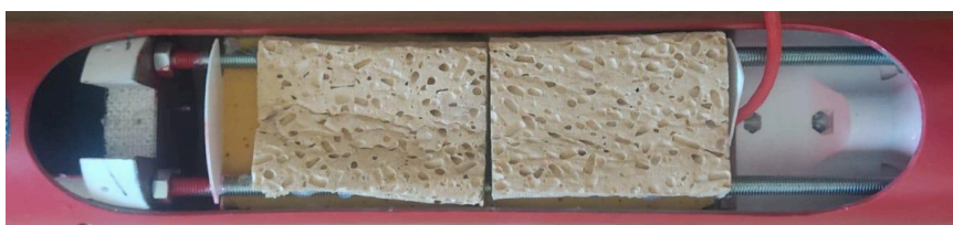
Fig 5.1 - Système employé pour redresser la fusée
