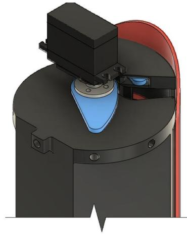
*Schéma 5: Vue isométrique N-E en couleur de l'assemblage de la trappe parachute (avec trappe, bague para, pièce de verrouillage pale, pale, moyeu et servo)*
