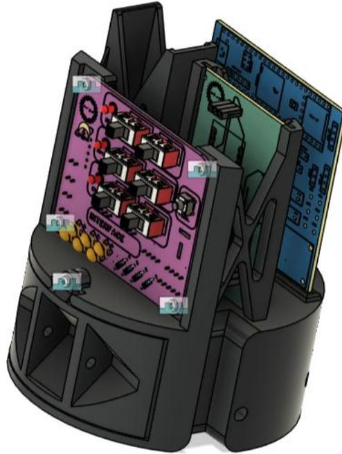
*Schéma 2: Assemblage de la bague électronique de MROM*
