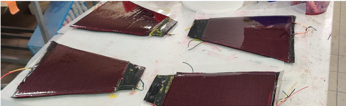
Figure 5: Ailerons à la fin de l'étape de pose de la résine
