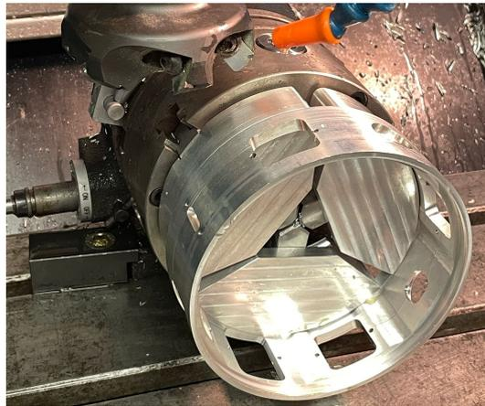
Figure 13: Usinage de la bague électronique
