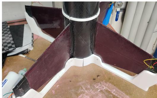
Figure 6: Ailerons entrain d'être collés sur le tube
