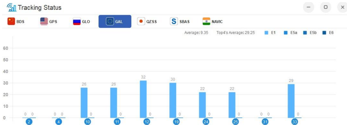
Figure 4 - connexion satellite et trame reçue avec antenne externe
