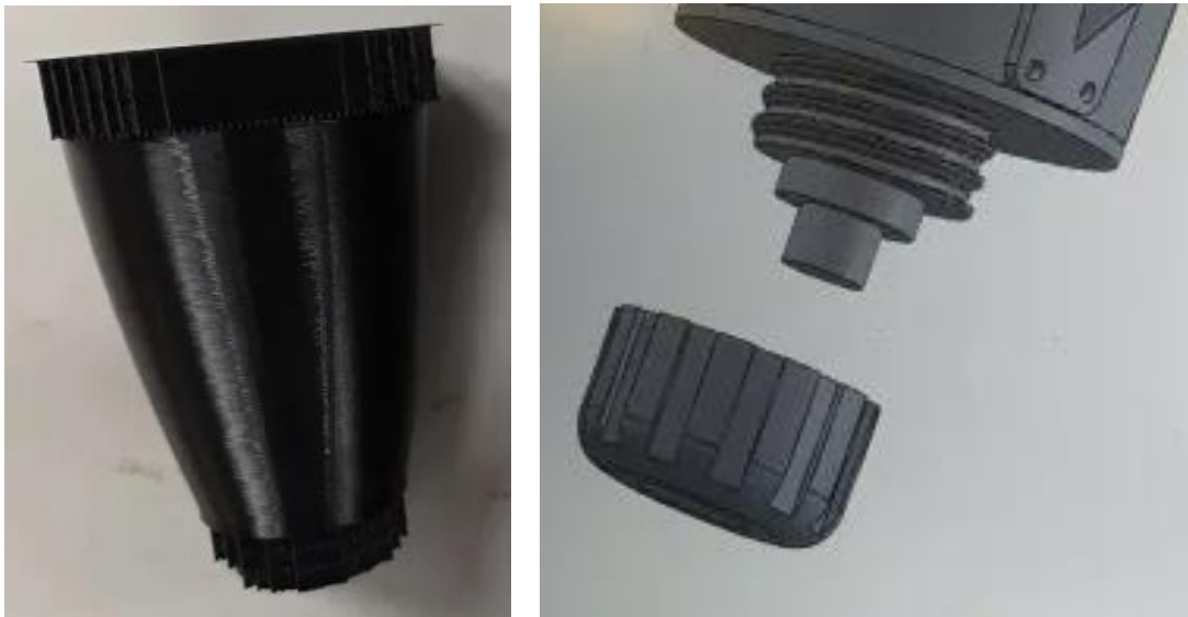
Figure 3 – Système de retenue du propulseur Pro-24 : modèle 3D (SolidWorks) et pièce correspondante imprimée en 3D.
