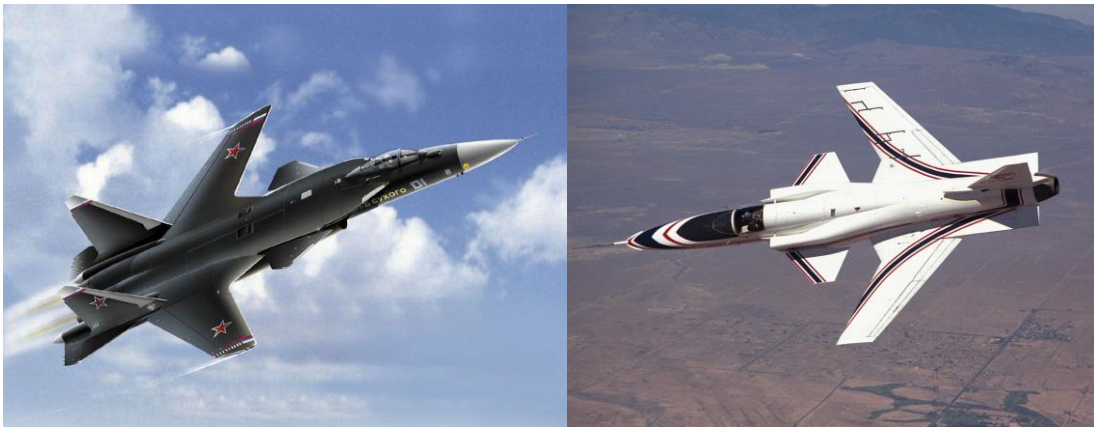
Figure 5 - Aile à flèche inversée : SU-47 et X-29
