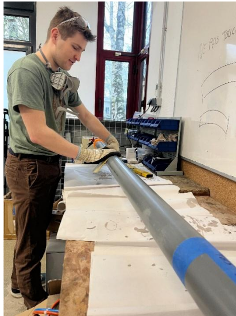
Figure 11 - Ponçage du PVC
