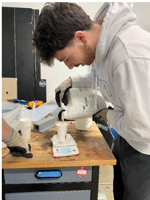
Figure 13 - Préparation de l'époxy
