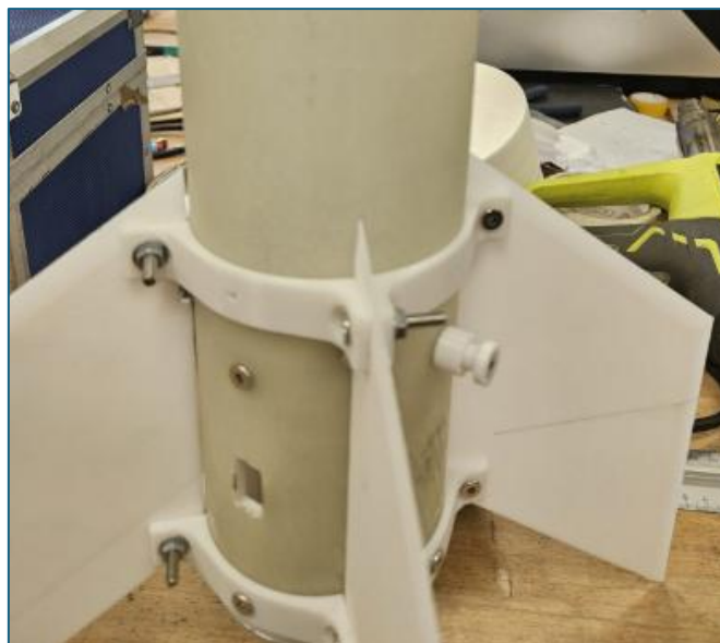
Figure 10 : Ailerons et supports d'ailerons, étage supérieur
