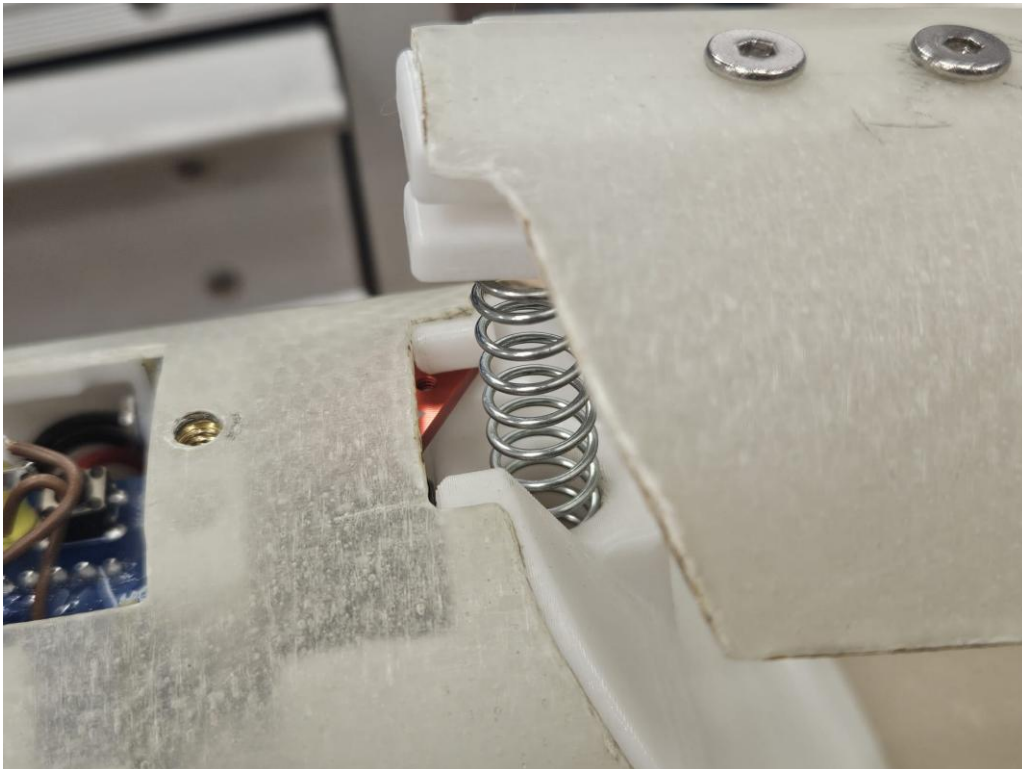
Figure 26 - Trappe en position ouverte, non bloqué par le servomoteur
