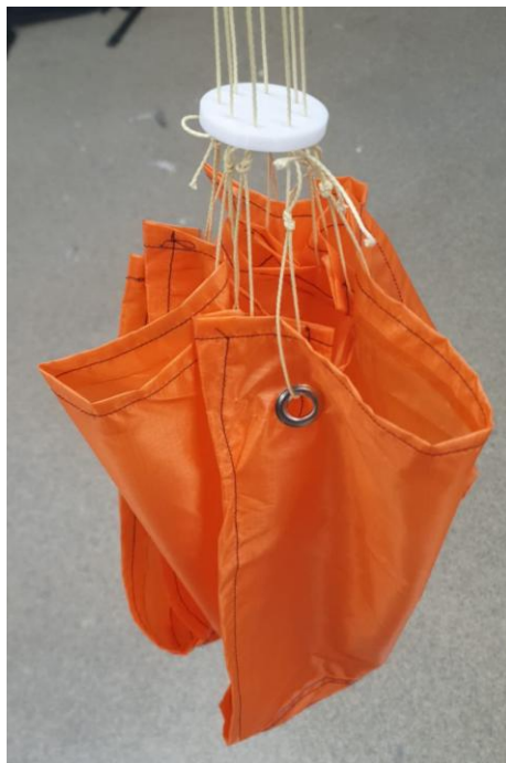
Figure 25 - Parachute avec ses suspentes et sa bague anti-torche
