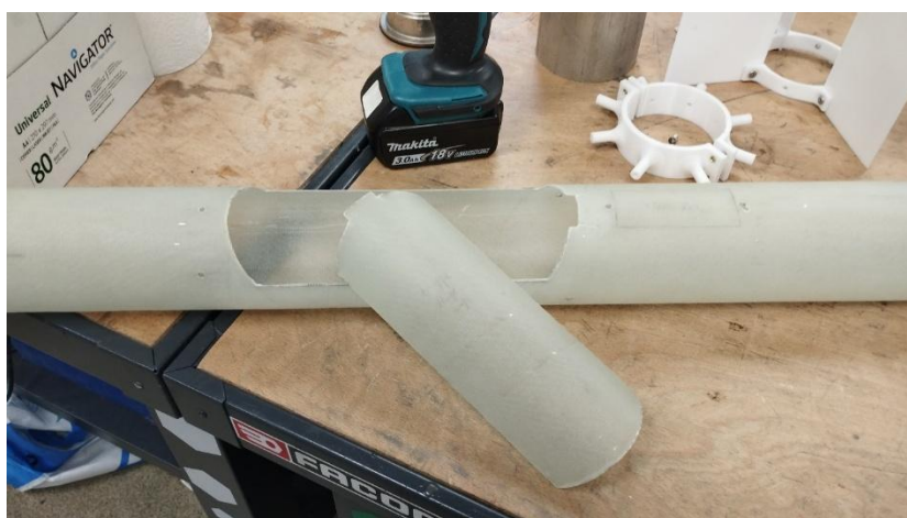
Figure 18 - Découpe des trappes pour la récupération
