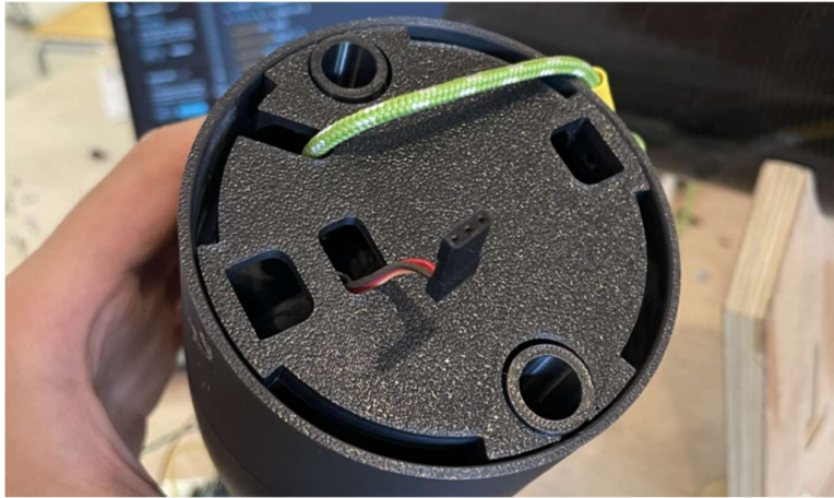
Fig. 18 Câbles du servomoteur avec connectique Dupont
