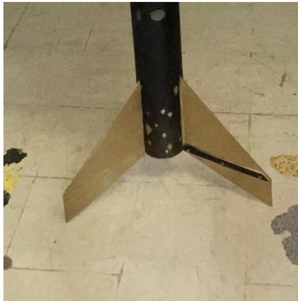
Figure 14: Photographie de l'aileron avec renfort en aluminium
