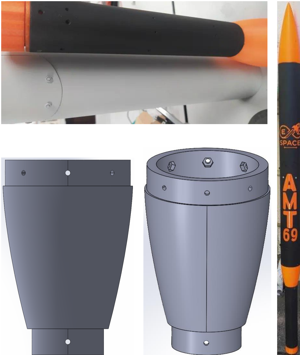
Figure 3 - Transition Haack et tube du bas : modèle 3D (SolidWorks) et pièce correspondante imprimée en 3D.
