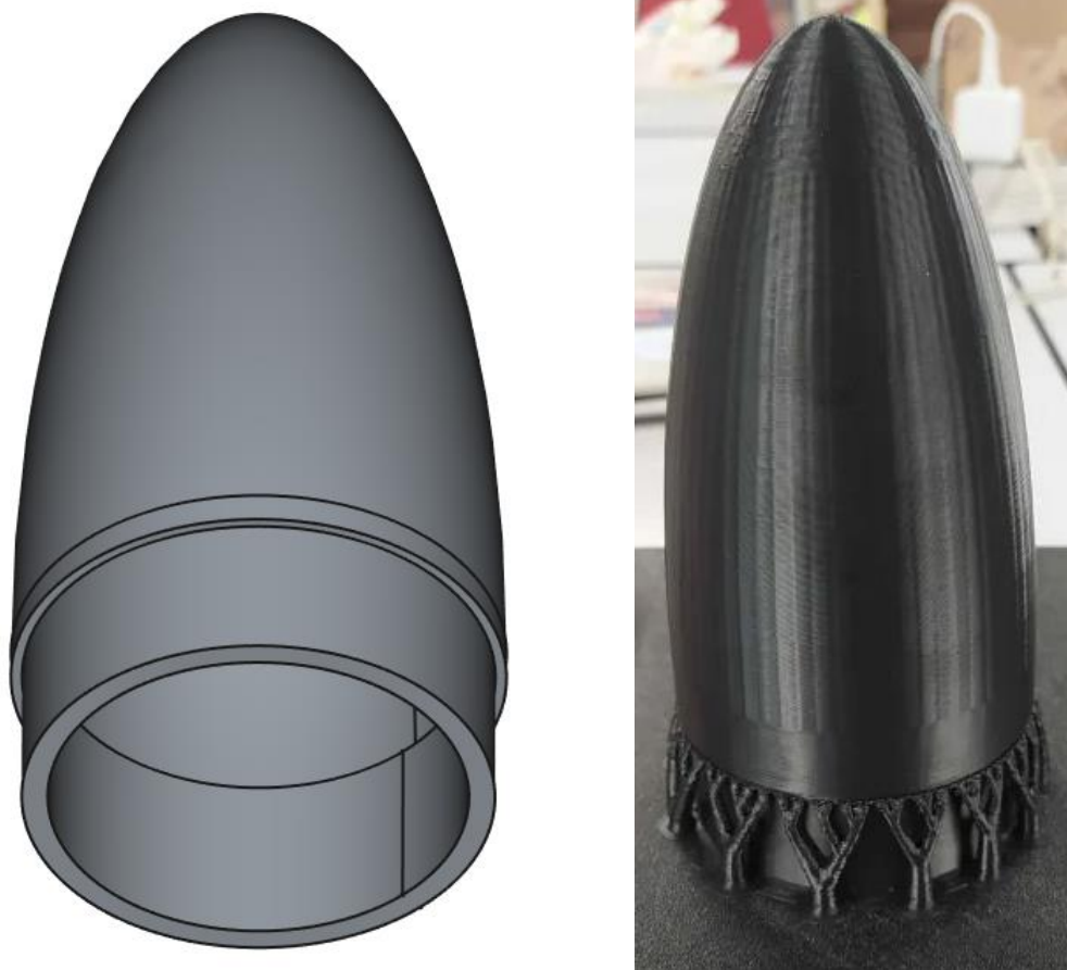
Figure 1 - Ogive ellipsoïdale : modèle 3D (FreeCAD) et pièce correspondante imprimée en 3D.
