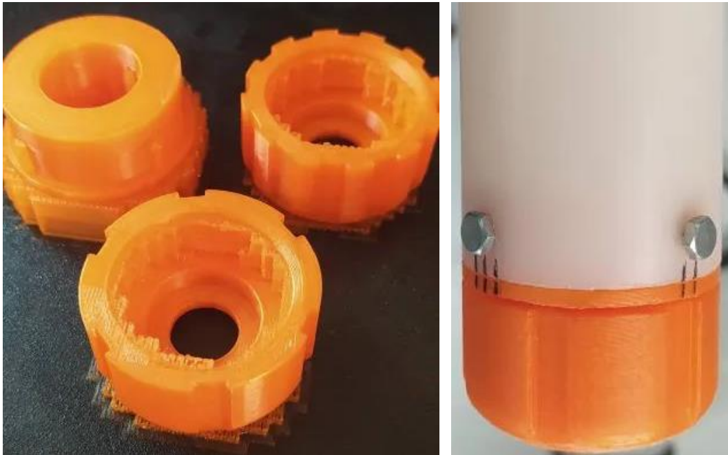
Figure 4 – Système de retenue du propulseur Pro-24 : modèle 3D (SolidWorks) et pièce correspondante imprimée en 3D.
