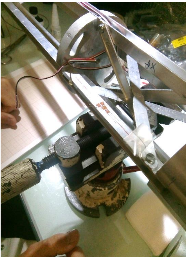
Figure 1: Pose des jauges de déformations
