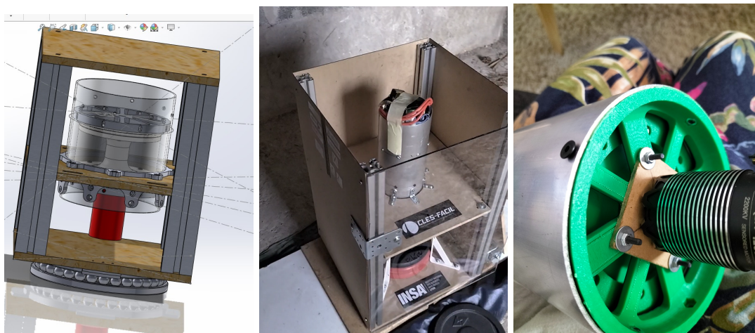
FIGURE 15 – Gauche - Design CAD / Milieu - Banc de test / Droite - le volant
