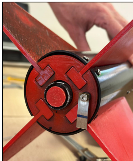
Figure 14: Onglet pour la fixation du propulseur
