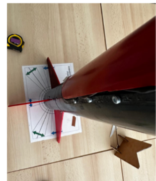
Perpendicularité des ailerons
