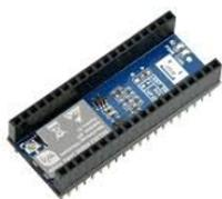
FIGURE 7 – Module de télémétrie LoRaWAN utilisé sur AéroSat
