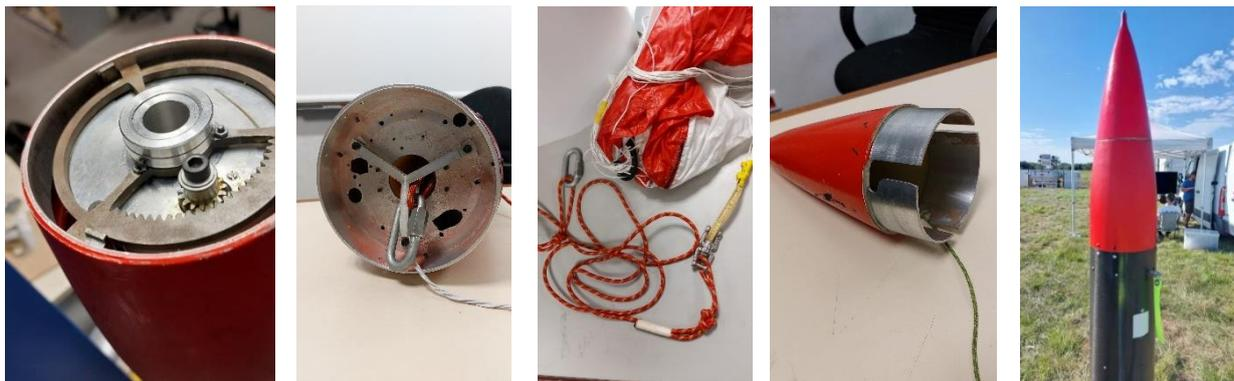
Figure 8 : vue parachute, système éjection et coiffe
