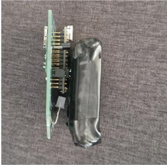
FIGURE 15 – Vue de gauche du détecteur de muons
