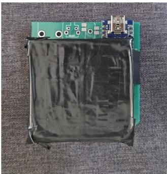
FIGURE 13 – Vue du dessus du détecteur de muons
