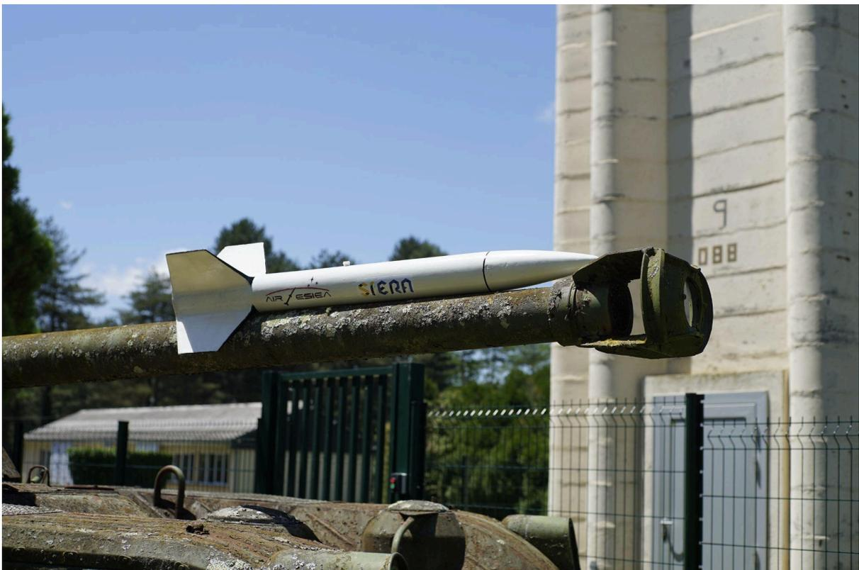
**Mnemonus est une minifusée visant à tester en condition réelles un ordinateur de vol modulaire basé sur le microcontrôleur RP2040 ainsi qu'un corps en composite stratifié développé en interne.**
