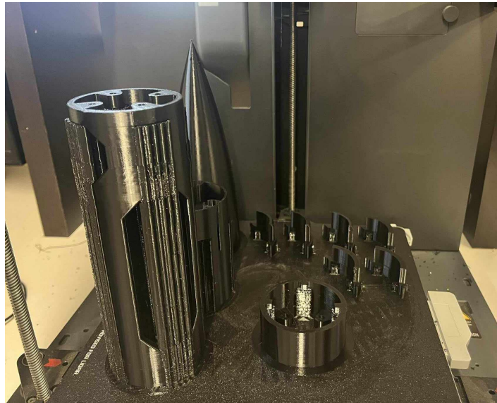
FIGURE 4 – Éléments imprimés en 3d pour la fusée
