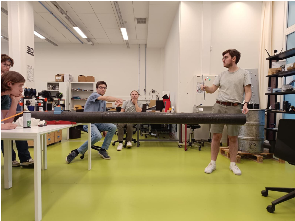
FIGURE 2.24 – Test de flèche réalisé pour évaluer les performances du système d’encastrement entre les deux étages (de séparation donc)
