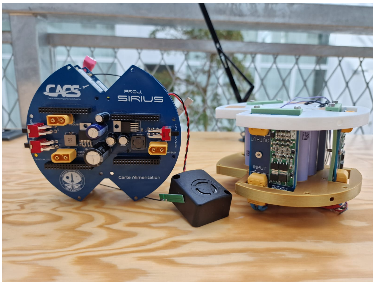
FIGURE 3.1 – Stack Bêta (à gauche), buzzer, et batteries de Bêta (à droite)
