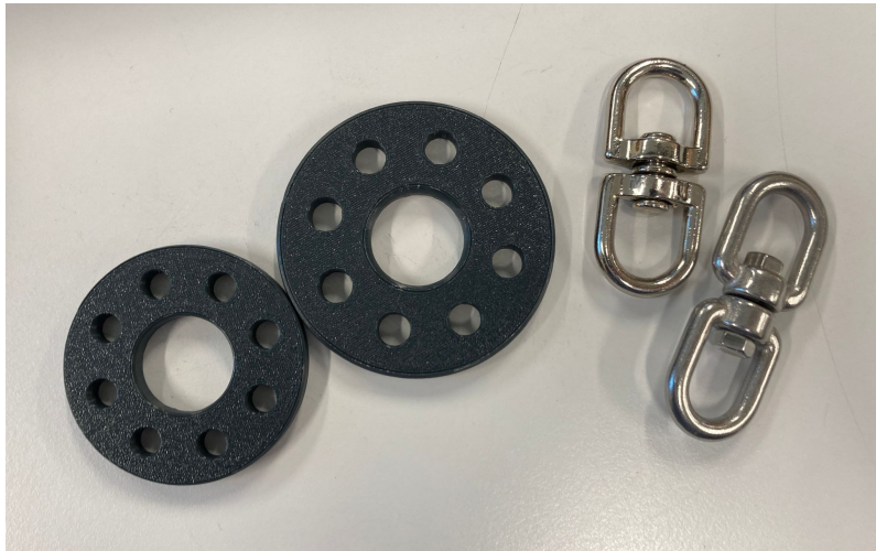
FIGURE 2.9 – Anneaux (en haut) et émérillons (en bas) des parachutes. Les deux émérillons sont les mêmes pour les deux parachutes. En revanche, l’anneau de Beta a un diamètre plus important (puisque les suspentes ont un diamètre plus grand).
