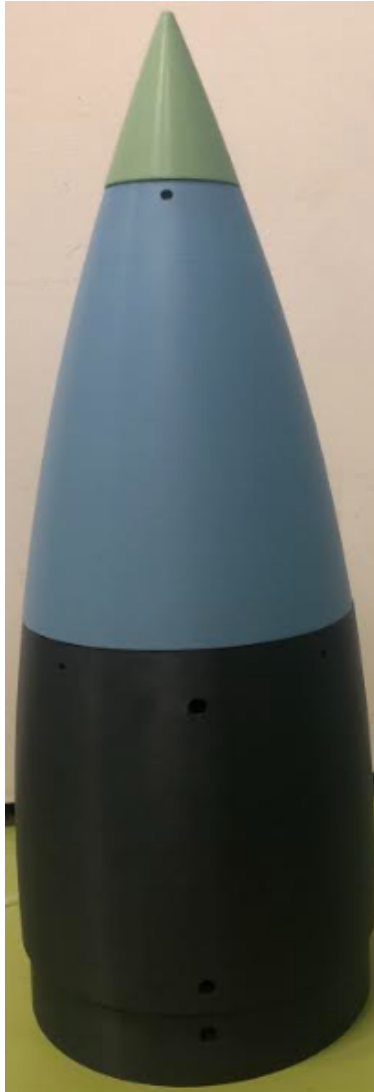
FIGURE 2.14 – assemblage des 3 parties de la coiffe
