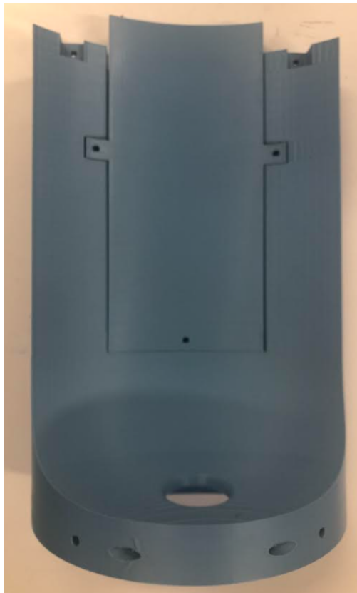
FIGURE 2.12 – Support parachute bêta avec porte d'accès à l'élec
