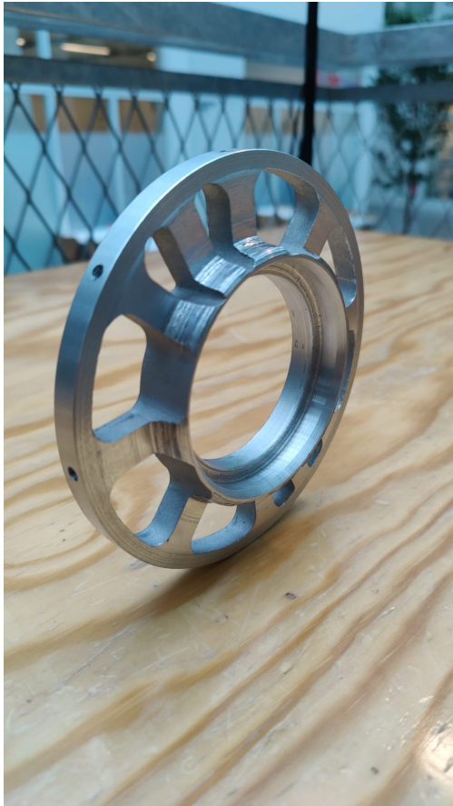
FIGURE 2.25 – Bague de reprise de poussée en aluminium.
