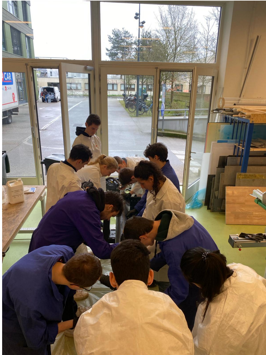
FIGURE 2.17 – Fabrication du tube Beta : le tube moulé mesure ici 2m10 de façon à avoir suffisamment de marge pour le découper et l'usiner par la suite. Une équipe de 10 personnes a été mobilisé pour la fabrication avec des postes et des rôles bien précis assignés à chacun.
