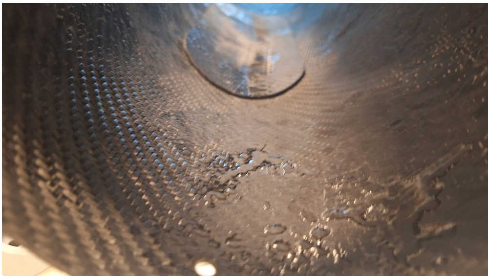
FIGURE 2.21 – Etat de surface intérieur des tubes après moulage. Les coulures d'époxy sont gênantes pour l'intégration des bagues à l'intérieur de la fusée, le ponçage est donc essentiel dans ce cas.
