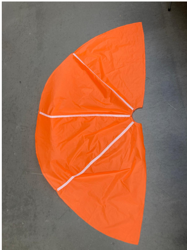
FIGURE 2.11 – Demi-toile de la toile du parachute de bêta. Cet angle met en évidence l'utilisation des biais (bandes blanches) entre les pétales pour venir renforcer les coutures.
