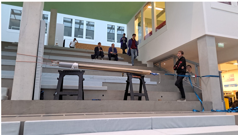
FIGURE 2.19 – Tentative de démoulage du tube
