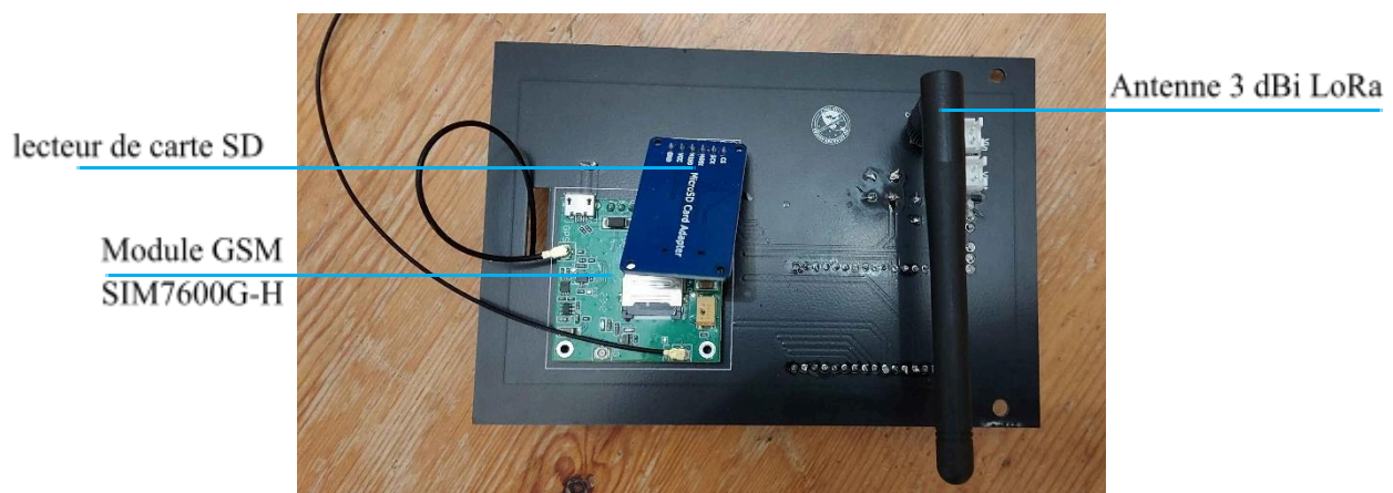
Figure 37 : Photographie du PCB de la télémessure (vue de dessous)
