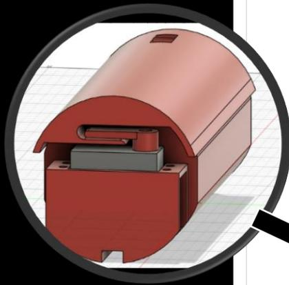
Trappe parachute : ce bloc est constitué de plusieurs pièces dont l'attache parachute (barre visible sur la bulle de droite). Un ressort (non visible ici) fait pression sur la porte de la trappe afin que l'éjection soit franche. Tout ceci est retenu par un servo moteur fixé à la trappe.
