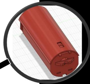
Support Jack et support caméra : ces pièces collées au corps de la fusée permettent de maintenir en place la partie femelle du jack ainsi que la caméra embarquée (fixée de l'autre côté).
