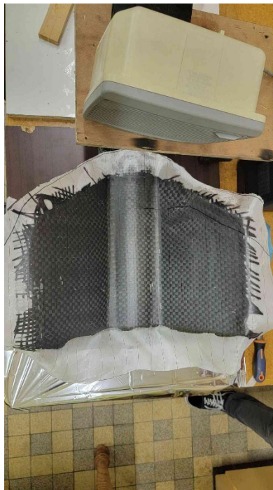
Figure 27 : Séchage de la résine époxy
