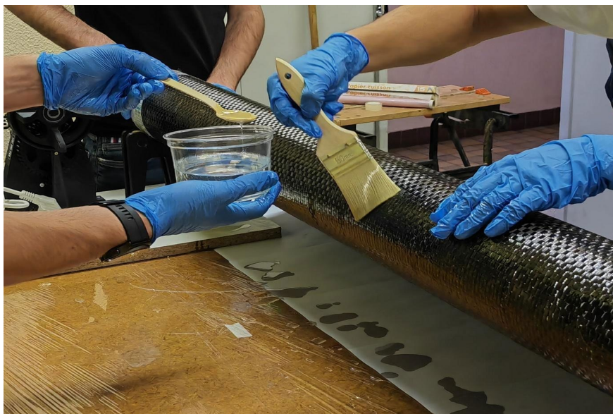
Figure 24 : Application de la résine époxy sur le tissu de carbone
