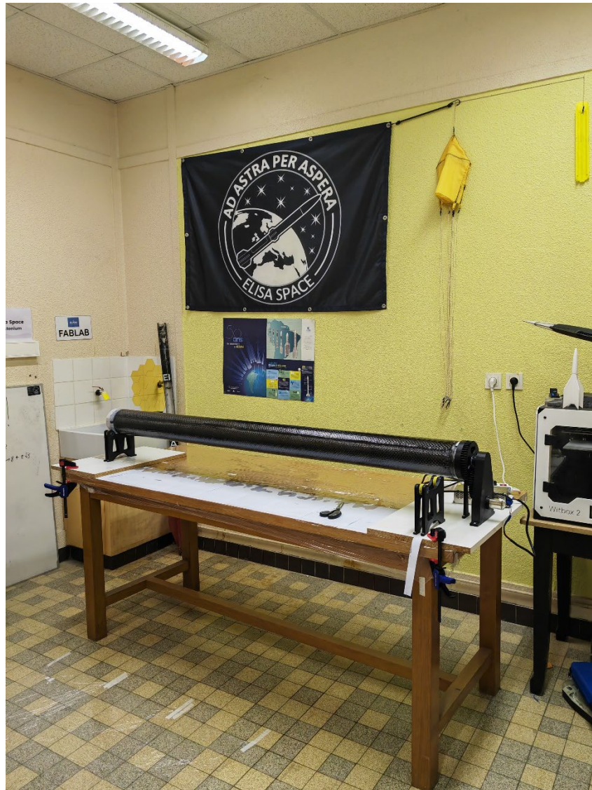
Figure 25 : Tube terminé et laissé en séchage
