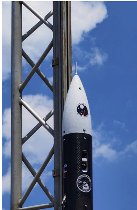
Figure 10 : Coiffe et Pitot de la fusée ELYTRA
