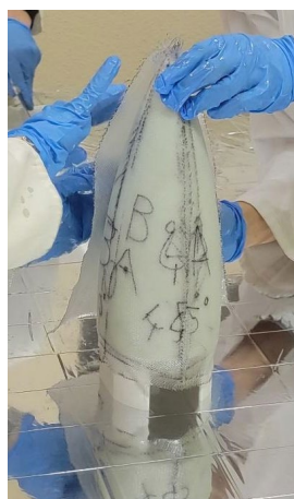
Figure 32 : Fabrication de la coiffe
