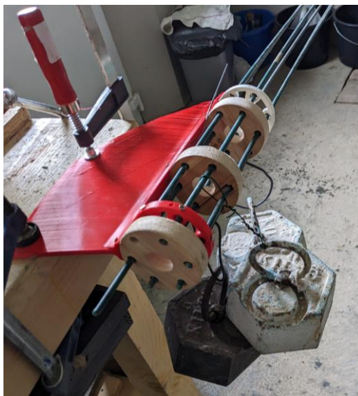
Test maison pour l'aileron avec 30kg
