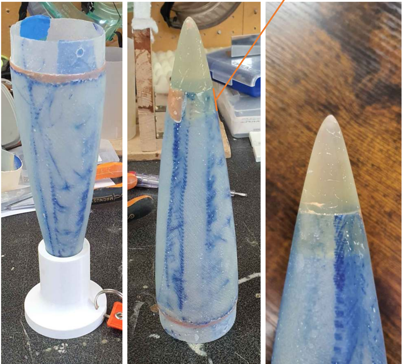
Figure 14 : Fabrication de la pointe de la coiffe
