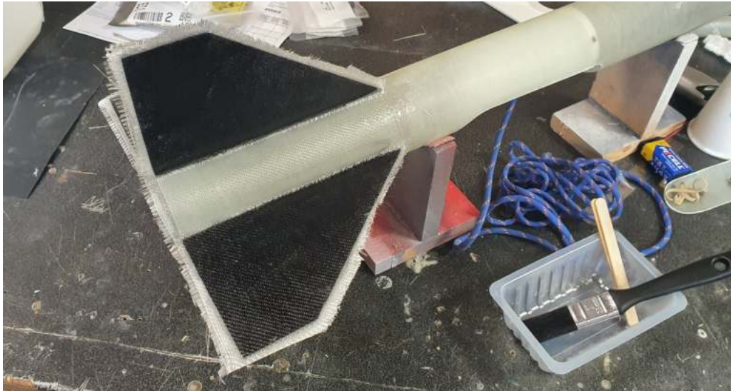
Figure 10 : Ailerons avec leurs renforts en fibre de verre
