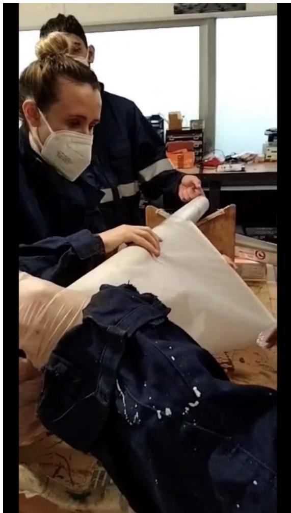
Création de la peau en fibre de verre. On peut souligner l'utilisation de papier de cuisson pour faciliter la séparation entre le tube de PVC servant de moule et les fibres déposés sur le papier cuisson. Plus tard le papier cuisson a été remplacé par de la fibre d'arrachage pour les minif suivantes, plus efficace dans cette mission.
