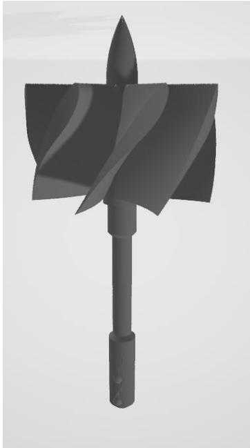
Arbre de turbine, les profils sont à un angle d'attaque qui varie de 30 à 60 degrés plus on s'éloigne de l'axe de rotation. Les deux parties de l'arbre de plus grand diamètre sont les endroits où se placent les roulements à billes.
