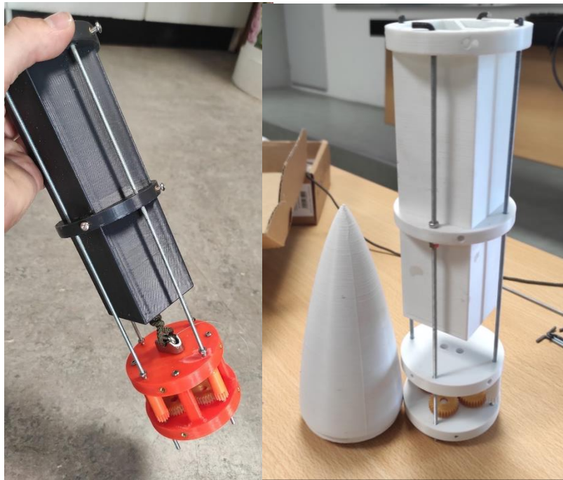
Photo 8. Logement du parachute + système d'éjection
