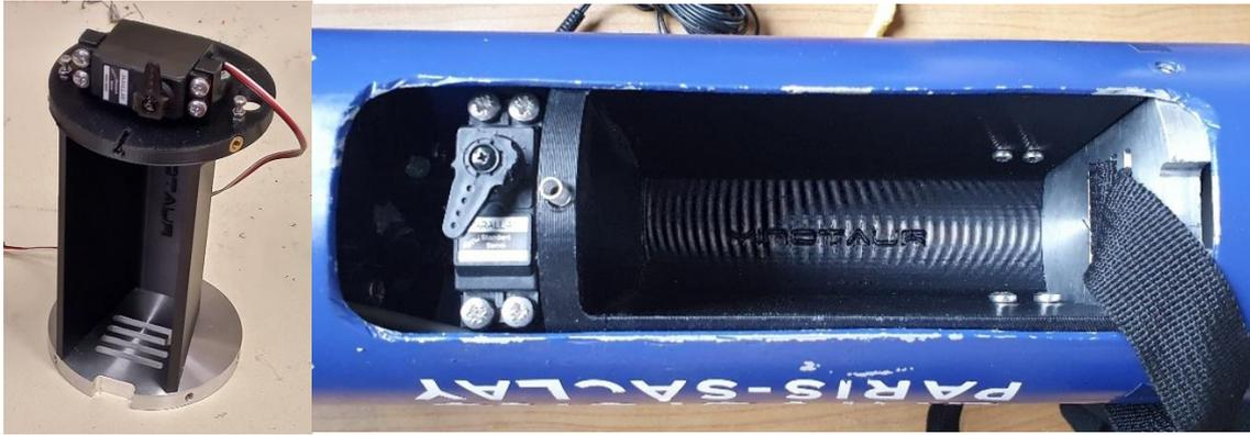
Figure 16 : rack parachute 1<sup>ère</sup> version, et le rack parachute après le vol de la fusée
