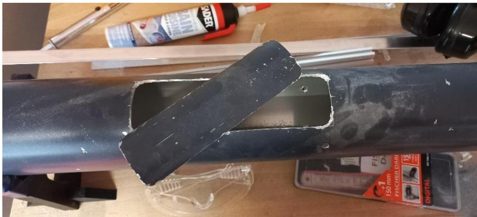
Figure 10 : découpe dans le tube de la trappe et de la porte pour le parachute
