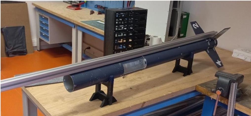
*Figure 20 : test des patins avec un profilé d'aluminium*
