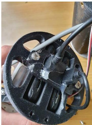
Figure 12 : Mauvaise idée de brancher les câbles par le bas !
