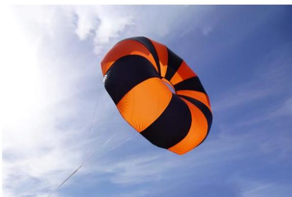
Figure 14 : parachute toroïdal
