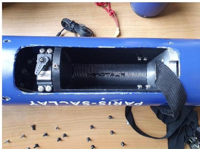
Figure 23 : Intégration du servomoteur
