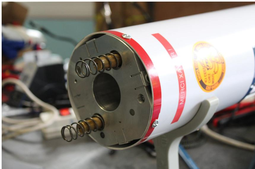
*Haut du 1er étage avec les ressorts autour des tiges en laiton pour le système de séparation*
