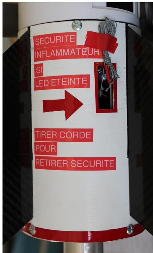
*Message informatif sur la peau pour les pyrotechniciens avec la LED et l'interrupteur de sécurité sur le côté*
