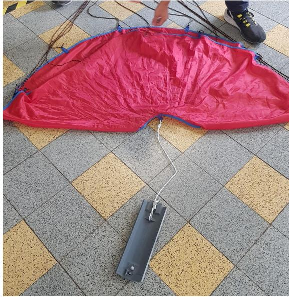
*Parachute du 2e étage avec suspentes et trappe*
