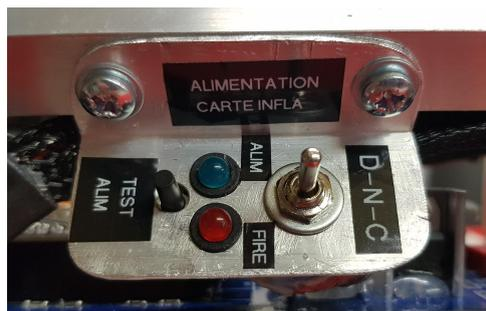
*Interface alimentation carte inflammateur avec interrupteur 3 positions, LED témoin et bouton poussoir pour tester l'alim*
