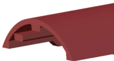
Figure 12 : Anneaux de verrouillage, un petit bras, attaché à un servomoteur, vient pivoter dans l'anneau pour verrouiller la porte
