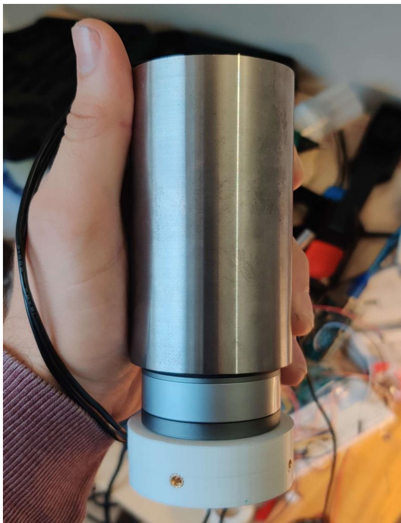
Figure 10 : Vue du volant d'inertie (usiner par PFT Innovaltech)
