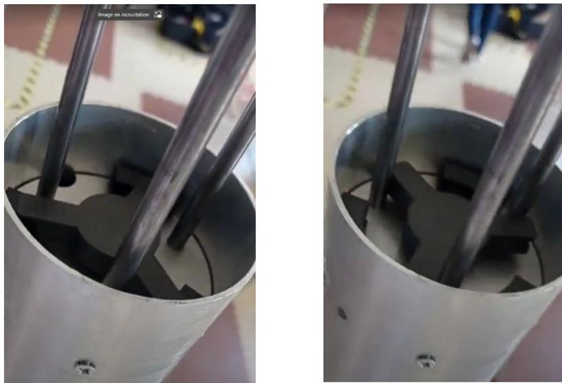
Figure 14 : Système de verrouillage de l'étage inférieur (verrouillé à gauche et ouvert à droite)
