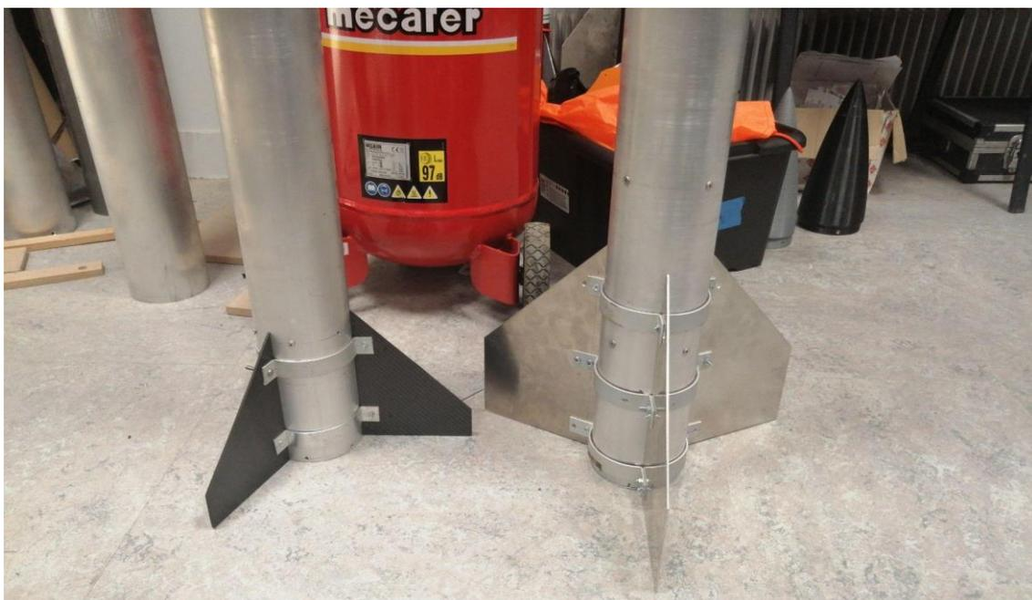
Figure 7 : Les ailerons fixés, haut à gauche et bas à droite
