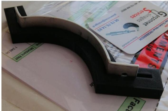
Figure 6 : Gabarit de formation pour les fixations
