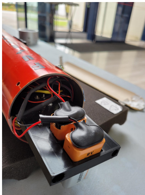
Figure 5 : Support imprimé de l'électronique
