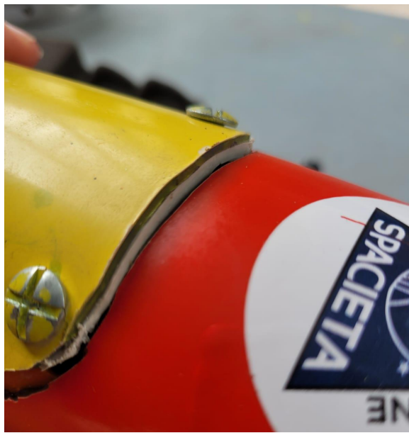
Figure 17 : trappe qui dépasse
