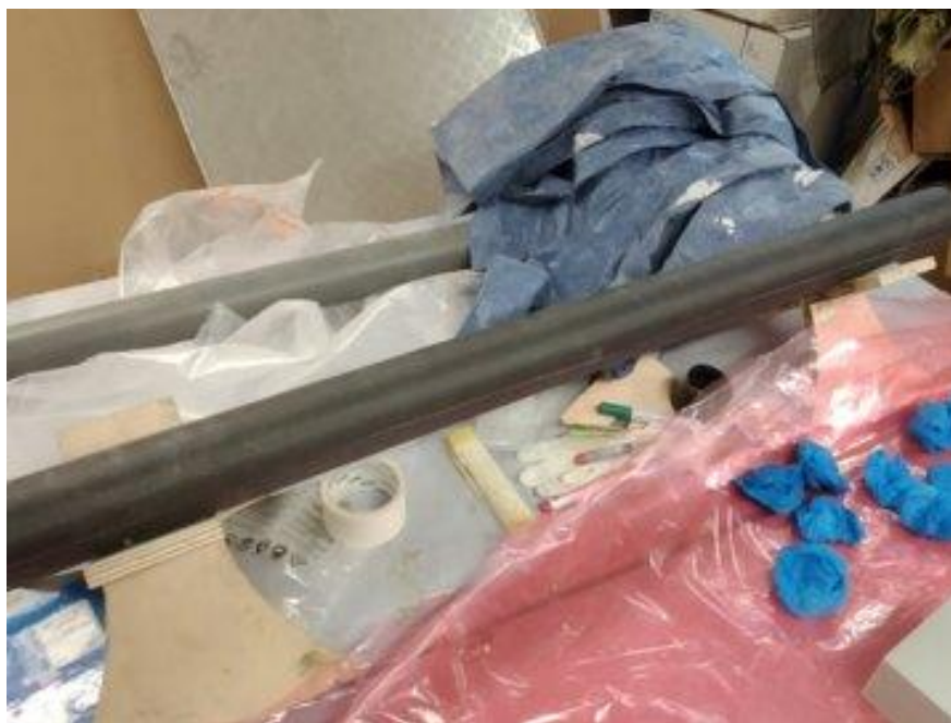
Figure 8 : Tube en fibre de carbone de Phobos
